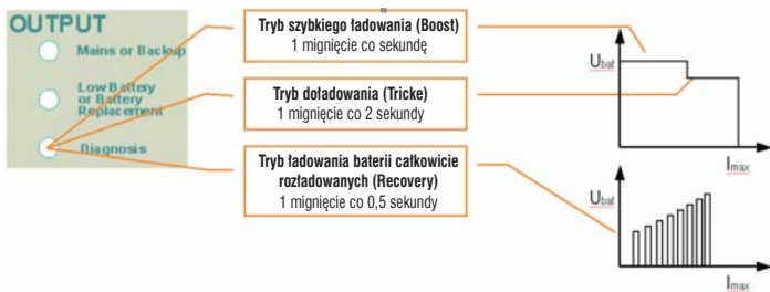
Rys. 6) Sygnalizacja trybu ładowania baterii podczas normalnej pracy (praca z sieci).
