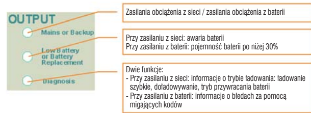
Rys. 3) Sygnalizacja stanu urządzenia za pomocą diod LED
